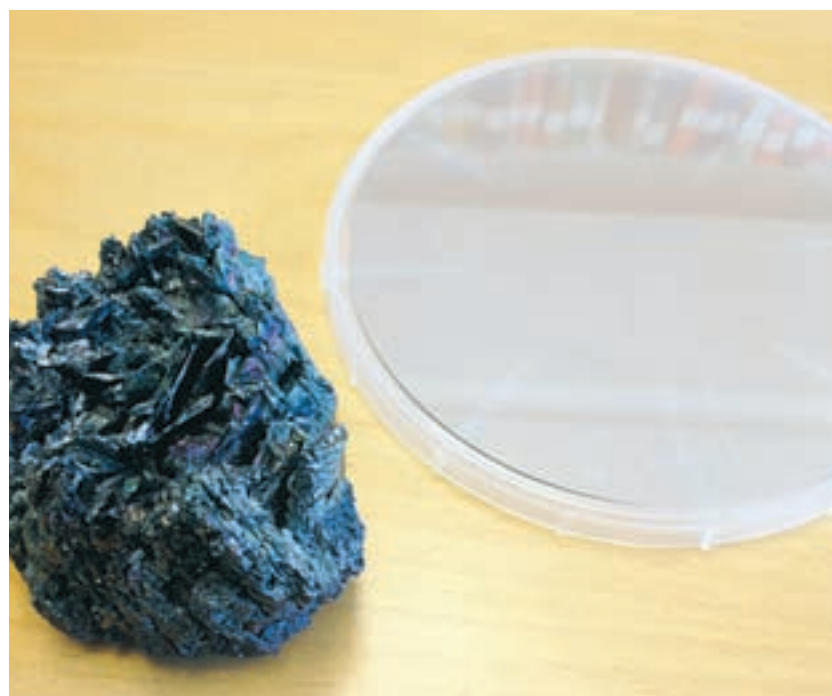
Kiselkarbid i två helt olika former. Kiselkarbiden till vänster används för slipändamål och kiselkarbiden till höger används i elektroniksammanhang.
